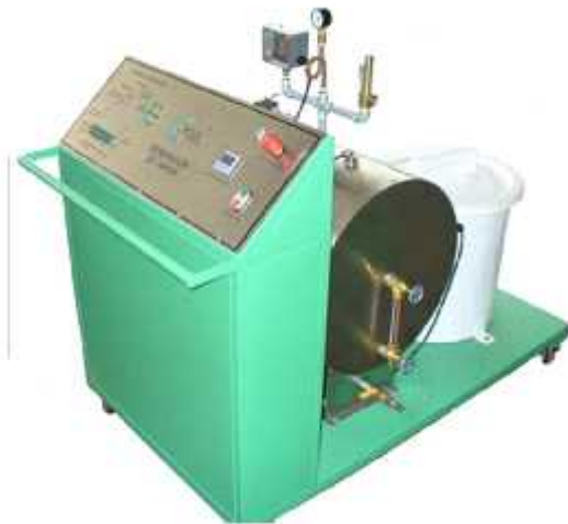
Generador de vapor
