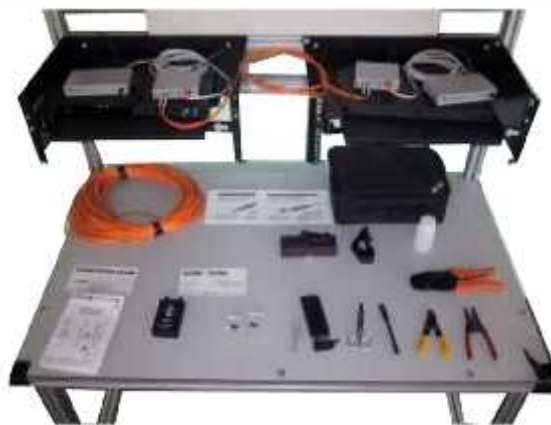
Mesa de conectorización de fibra óptica
